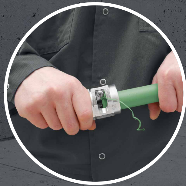
02 | 用粗挫把铝层去掉 (仅限于stabiAL PPR复合管)
