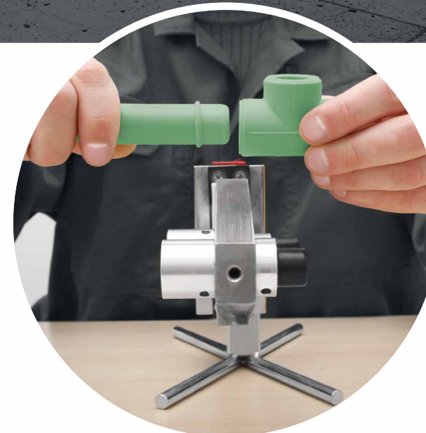
05 | 连接元件。 记录参数：连接时间。
