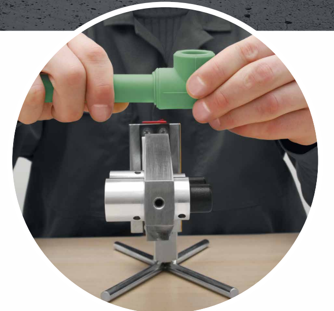
06 | 拧紧并冷却接口。 记录参数：冷却时间
